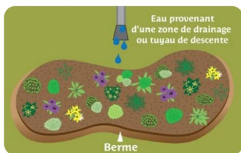
Une berme est un « mur de terre » qui capte et retient l'eau qui s'écoule dans le jardin pluvial. Les bermes sont essentielles si le jardin est installé sur une pente. La pente aidera à déterminer la hauteur de la berme, qui doit créer un périmètre de même niveau tout autour. Une berme doit avoir une largeur d'environ 30 cm (1 pi) ainsi qu'être compactée et recouverte de paillis ou de graines de gazon.
